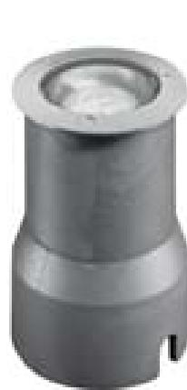
Beim brilliance 20 W dient die Bodeneinbauhülse zusätzlich für die großflächige Wärmeableitung an das umgebende Erdreich. Der LED Strahler ist mit der Einbauhülse verschraubt. Zum Schutz vor Korrosion ist die Aluminium Bodeneinbauhülse mit einer speziellen Eloxalschicht überzogen.
