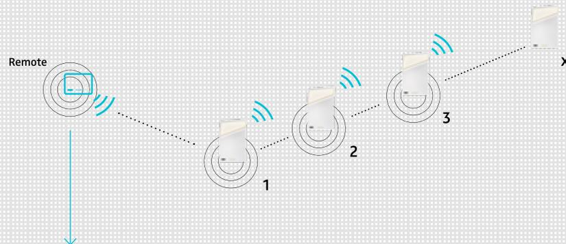
Die Winglet arbeitet nach dem Gruppen-Prinzip. Wird eine Leuchte per Gestensensor aktiviert, so tauschen sich diese drahtlos miteinander aus, schalten sich gleichzeitig ein oder dimmen auf identisches Niveau. Noch mehr Komfort bietet der überall frei platzierbare Funkschalter (Remote).
